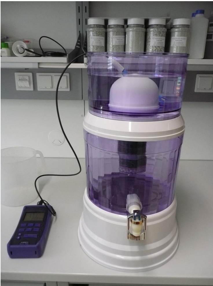
Abb. 3: Fertig installiertes YVE-3000-Wasserfiltersystem für Probe 2 (ohne Mineralienkorb)
